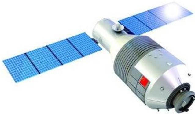
天宫一号是我国第一个目标飞行器和空间实验室，2011年9月29日21时16分3秒在酒泉卫星发射中心发射。2011年11月3日凌晨实现与神舟八号飞船的对接任务。2012年6月18日下午与神舟九号对接成功。2013年6月13日13时18分，与神舟十号飞船完成自动交会对接。它由实验舱和资源舱构成，全长10.4米，最大直径3.35米，总重8495千克，在轨寿命2年。试验舱外部装有防护板，具有一定的空间碎片和微流星防护的作用，前端安装对接机构以及交会对接测量和通信设备，用于支持与飞船的交会对接；资源舱外部安装太阳能电池翼和发动机等，为轨道机动提供动力，为飞行提供能源。
