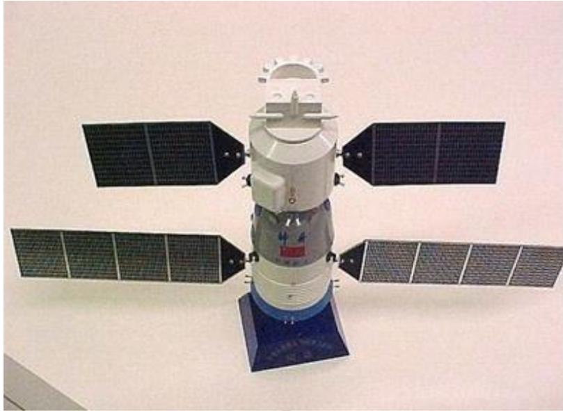
神舟飞船是中国自行研制，具有完全自主知识产权，达到或优于国际第三代载人飞船技术的飞船。神舟系列载人飞船总长约 7.4-9.2 米，整船重约 8 吨，最大直径约 2.8 米。最前端可安装交会对接机构，与其它航天器、未来空间实验室和空间站对接。这是神舟载人飞船 1:2 模型，高 5.2 米，直径 1.7 米。
